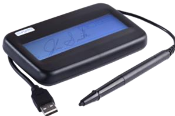
Slika 14. Uređaj za uzimanje uzorka potpisa [62]
