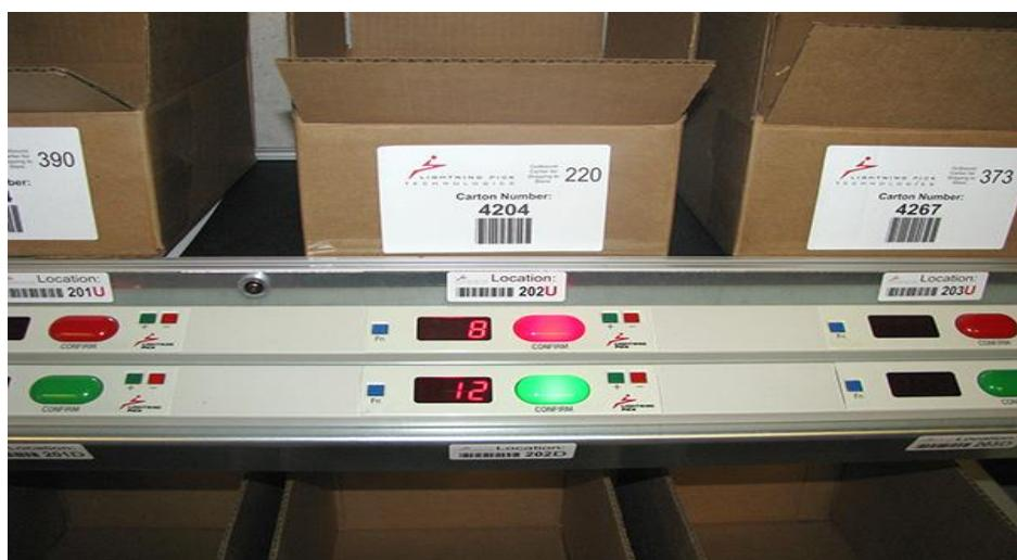
Slika 6: Primjer Pick-To-Light uređaja u skladištu (Dostupno na:
