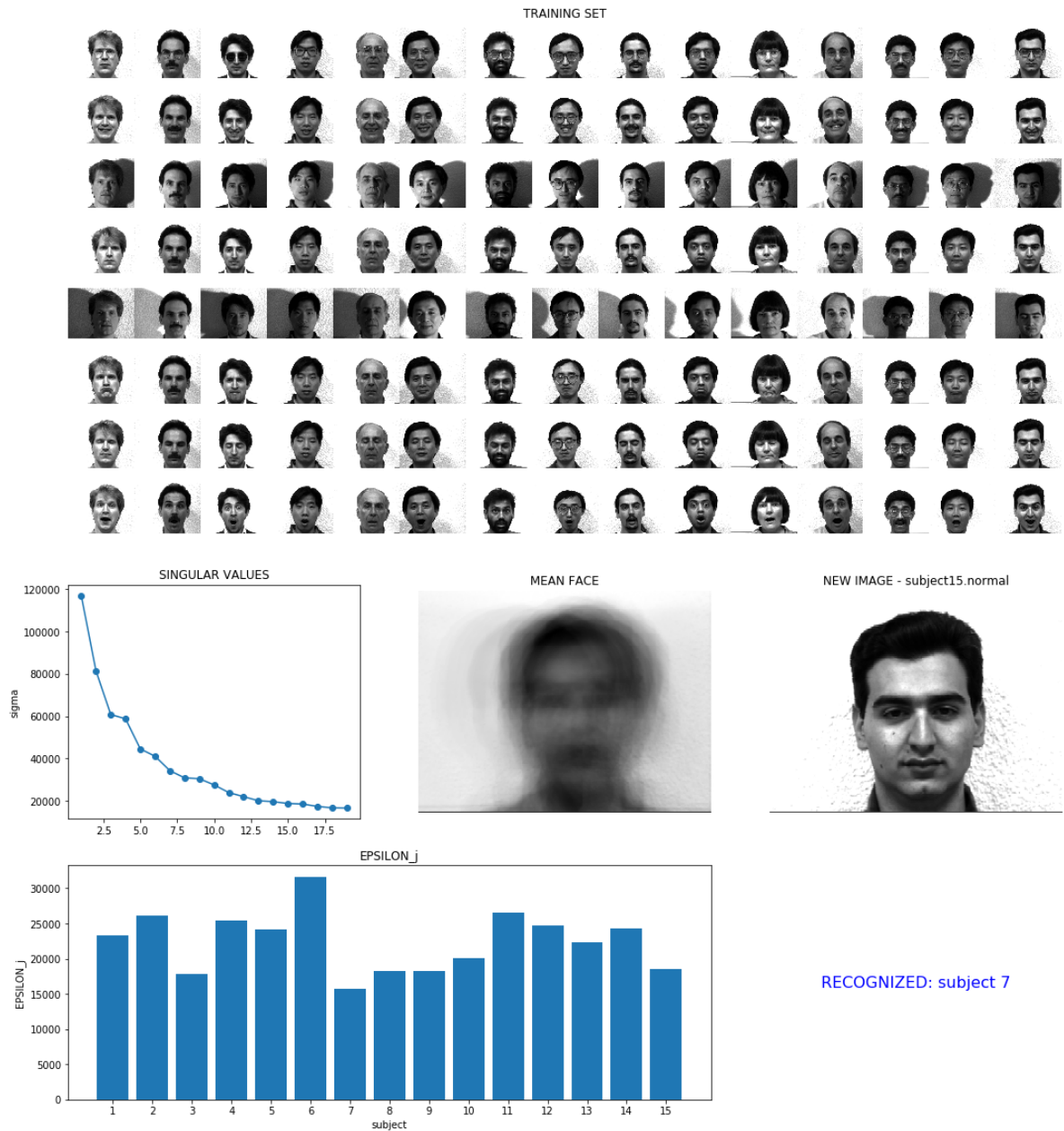
Slika 19: Krivo prepoznat pojedinac 7 umjesto pojedinca 15 na podacima za treniranje TD8
