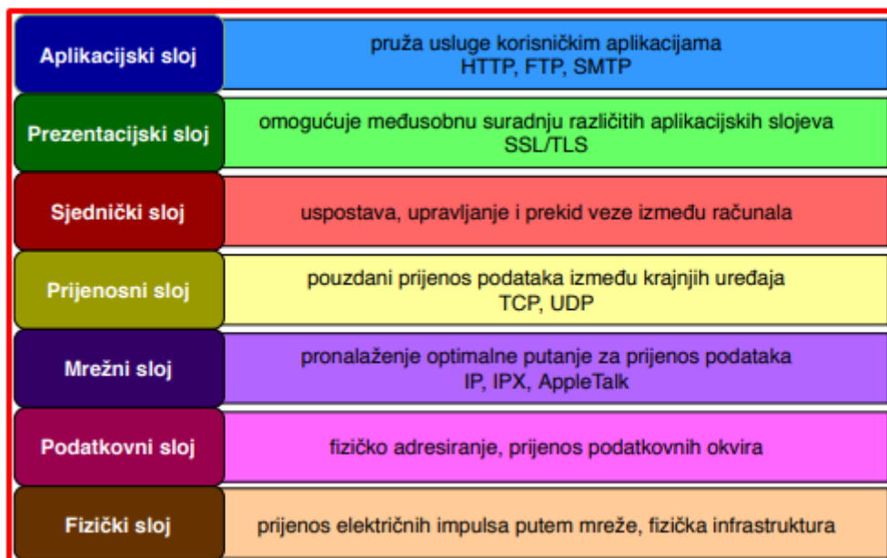
Slika 1. Osi model (vlastita izrada prema opisu iznad)
