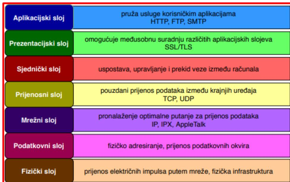
Slika 1. Osi model (vlastita izrada prema opisu iznad)
