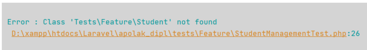
Slika 12: Prikaz rezultata provedbe neuspješno izvršenog testa (ne postoji klasa Student)
