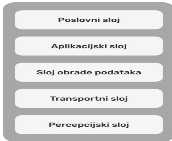
Slika 3. Model petoslojne arhitekture sustava interneta stvari (Izvor: Autor izradio prema [21])
