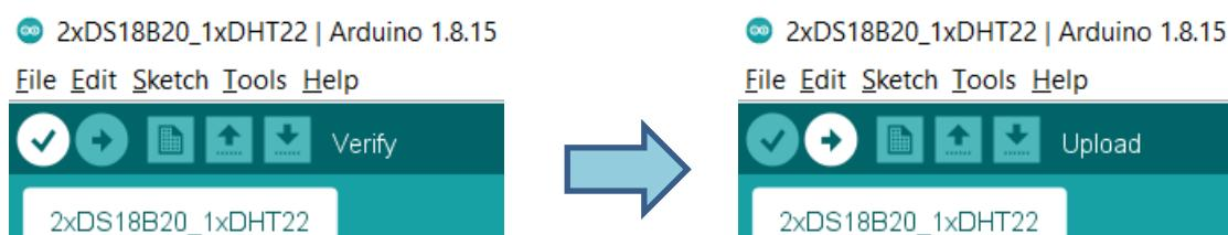
Slika 5. Verificiranje i slanje koda na ESP32
