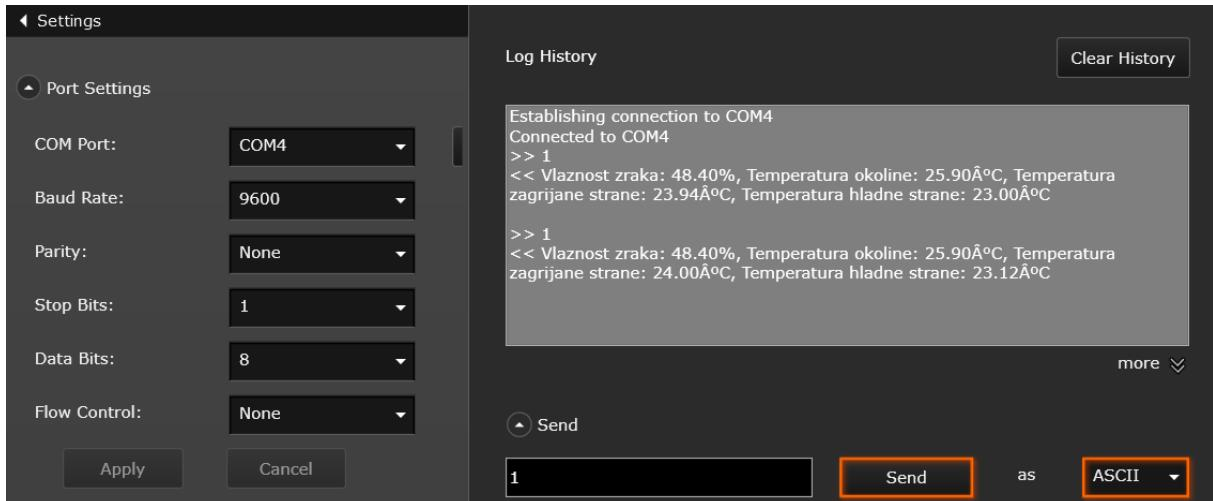
Slika 13. Konfiguracija ESP32 mikrokontrolera u BenchVue programu
