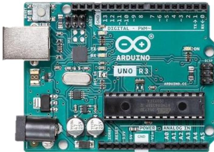
Slika 1: Arduino UNO pločica (Izvor: [Arduino.cc](http://Arduino.cc), (bez dat.))
