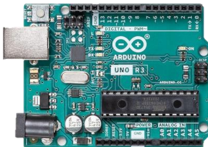
Slika 1: Arduino UNO pločica (Izvor: Arduino.cc, (bez dat.))
