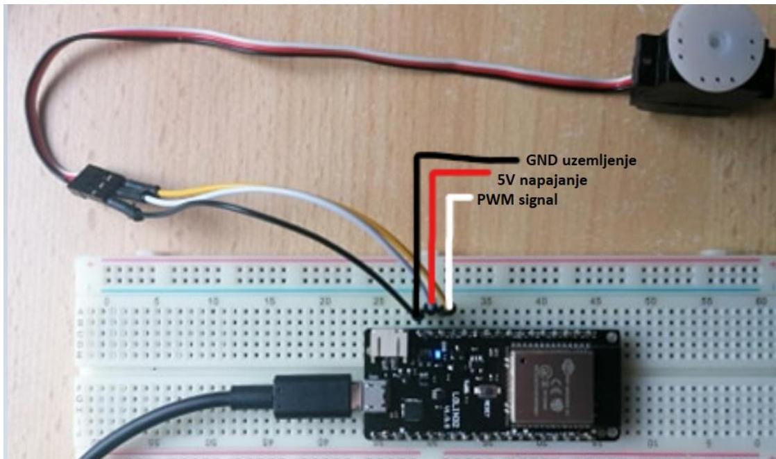
Slika 6: Povezivanje servo motora na Wemos pločici (Vlastita izada, 2021.)
