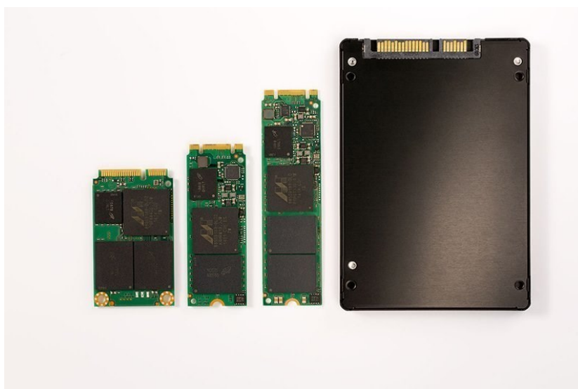
Slika 12. Oblici SSD-ova (Izvor: A. S. Gillis, C. Sliwa (bez dat.))
