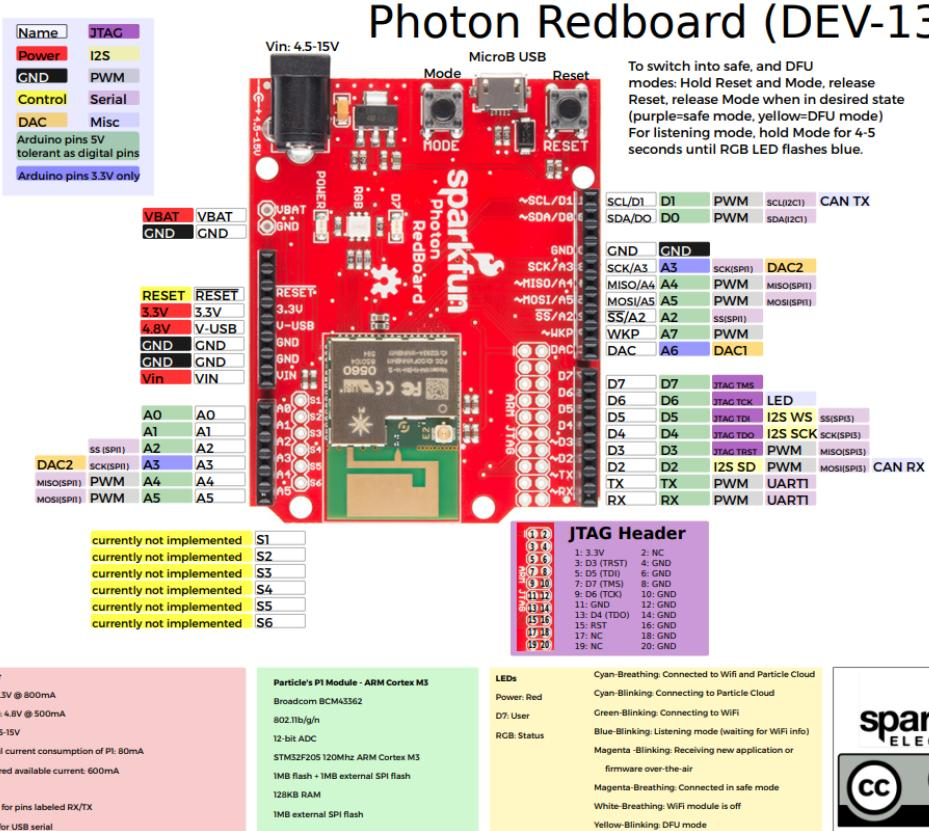
Slika 5: Pinout mikrokontrolera SparkFun Photon RedBoard (Izvor: [SparkFun, 2022](#))
