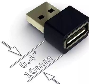
Slika 8: Hardverski bežični USB keylogger poduzeća Keelog [37]
