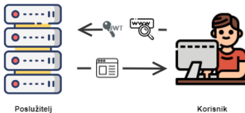
Slika 31. Komunikacija bez pamćenja stanja
