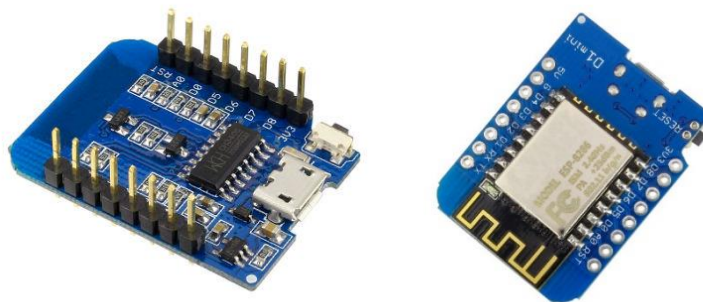
Slika 5. - ESP8266 D1 Mini WiFi Dev Bord (Izvor: addicore.com, 2023.)
