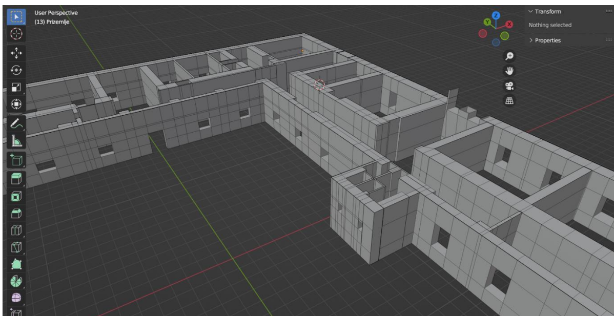
Slika 17. Primjer mnoštva Loop cut -ova korištenih za izradu prozora, vrata i drugih otvora (vlastita izrada, 24.7.2023.)
