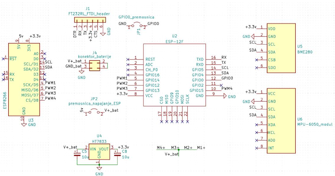
Slika 10. Shematski prikaz glavnih komponenti drona (Izvor: Izrada autora)
