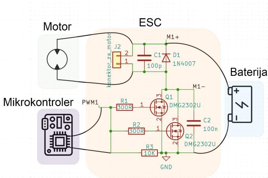
Slika 11. Shematski prikaz ESC-a i asociranih komponenti (Izvor: Izrada autora)
