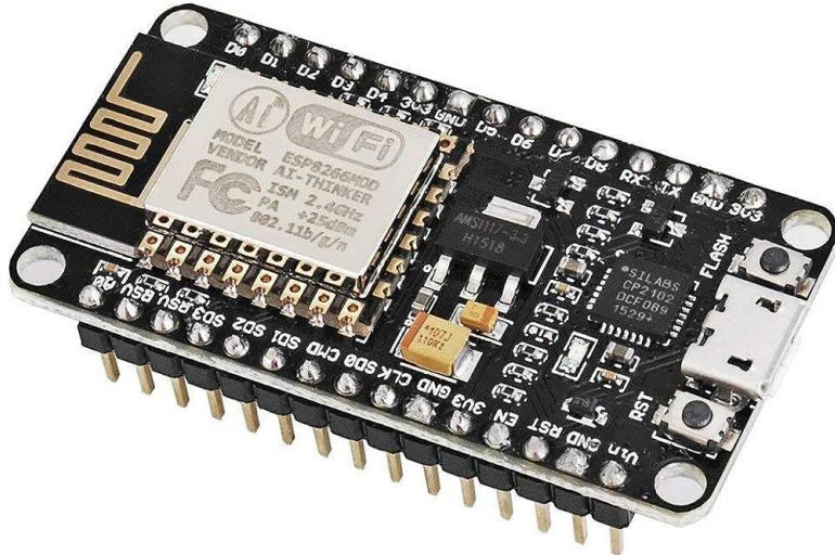
Slika 5 Prikaz ESP8266 razvojne pločice (Izvor: Kolban, 2016.)
