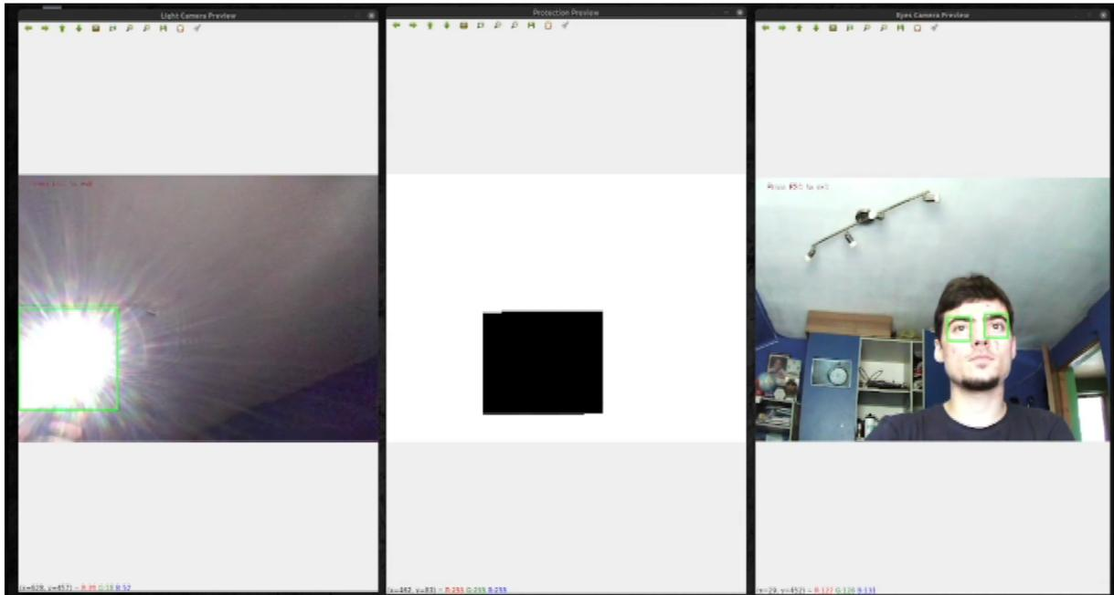
Slika 22: Prikaz prozora koji prikazuje zaštitni okvir zajedno sa prozorima koji prikazuju analizirane okvire koji prikazuju oči i svjetlost dok još zaštitni prozor nije premješten na LCD matricu. [autorski rad]
