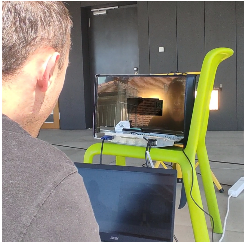
Slika 26: Prikaz iscrtanog crnog pravokutnika na LCD matrici koji spriječava svjetlost [autorski rad]
