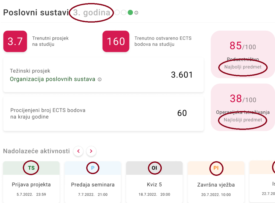
Slika 26: Zaokruženi elementi koji ne zadovoljavaju WCAG smjernice [autorski rad]
