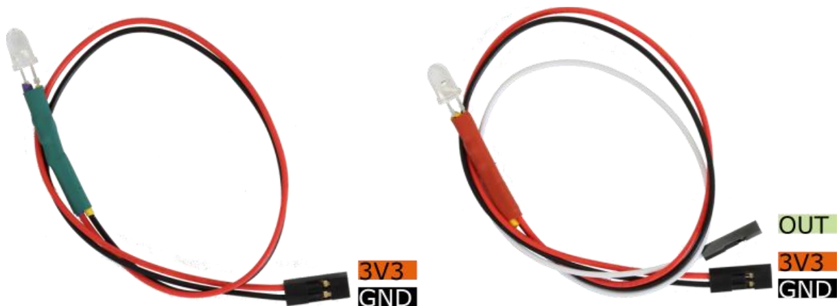
Slika 12. Barijera i LED dioda
