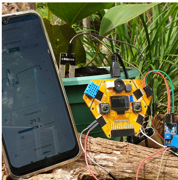
Slika 1: Primjer sustava za praćenje podataka na biljkama; preuzeto iz [4]
