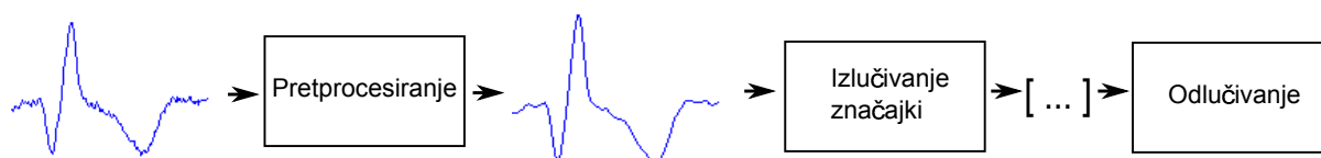
Slika 2: Tipični koraci u računalnoj obradi EKG signala
