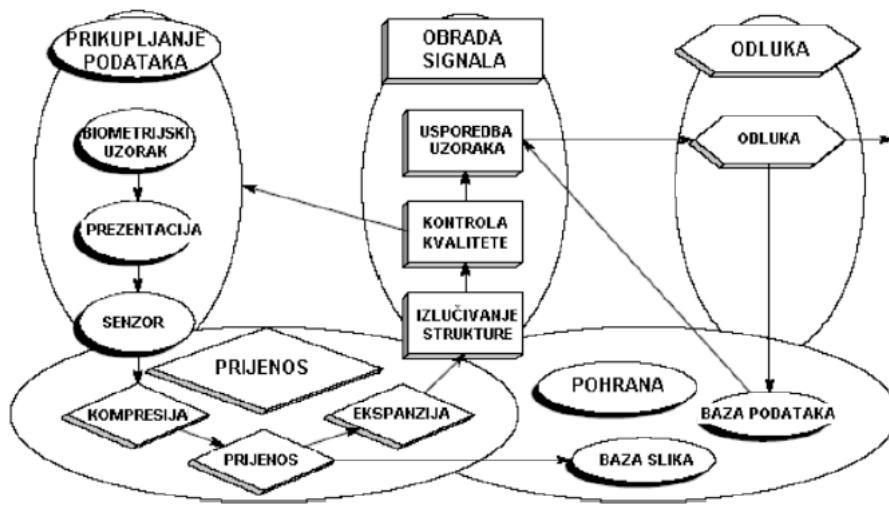
Slika 1 Uopćeni prikaz biometrijskog sustava sa podsustavima [27]
