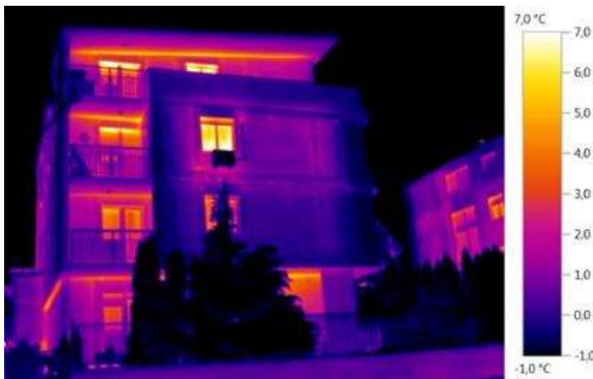
Slika 3-4. Termografski snimak zgrade iz okoliša
