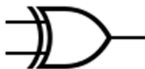
Slika 1: Simbol ekskluzivnog ILI logičkog sklopa
