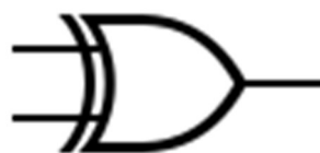
Slika 1: Simbol ekskluzivnog ILI logičkog sklopa
