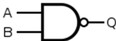
Slika 3: Simbol NAND logičkih vrata
