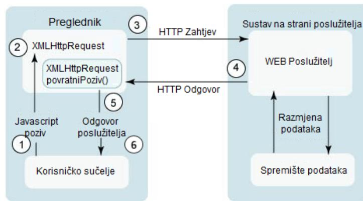
Slika 1. Postupak izvođenja Ajax tehnike (How AJAX works?, 2018)
