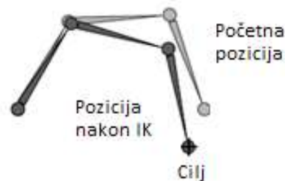
Slika 3. Inverzna kinematika (6.,str.596)
