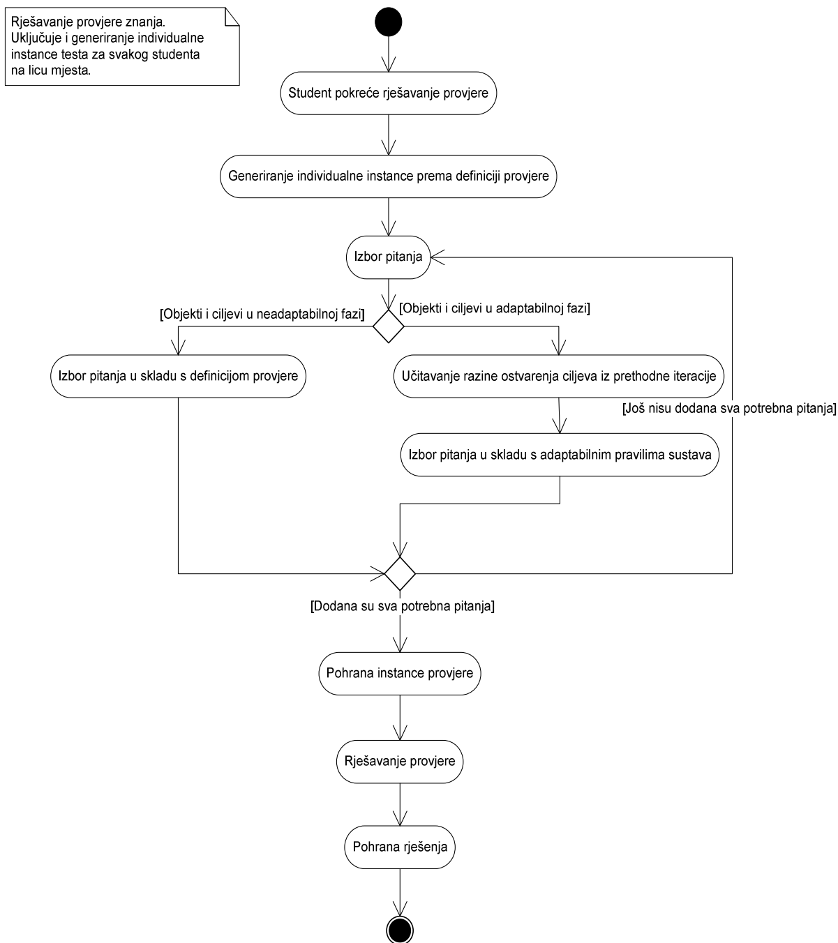
Slika 22. Koraci generiranja i rješavanja pojedinačnih instanci testova
