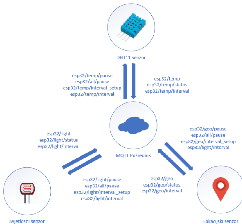
Slika 33: Način komunikacije IoT uređaja i MQTT posrednika
