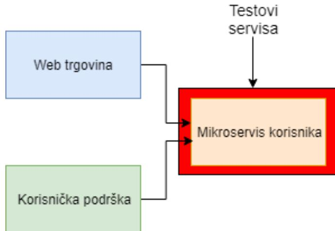
Slika 21 Prikaz opsega testiranja servisnih testova [5]
