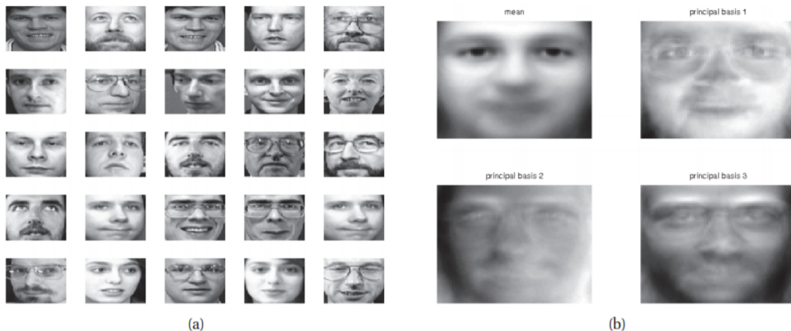
Slika 22: Prikaz (a) 25 nasumično odabranih 64x64 pikselskih slika (b) Prosječni vektor i prva tri vektora komponentnih osnova (Eigenfaces) [3, str. 12]
