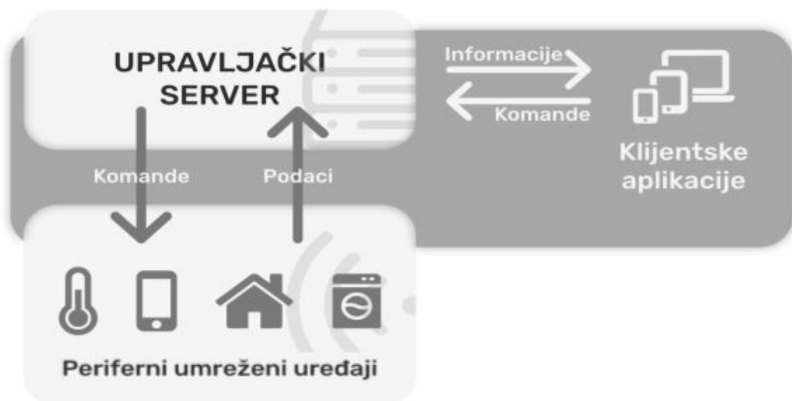
Slika 4. Model oblako - centrične arhitekture sustava interneta stvari (Izvor: Autor izradio prema [42])
