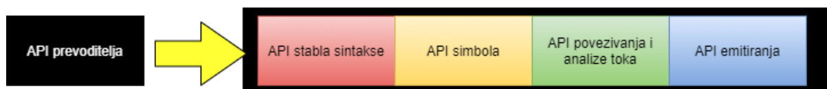
Slika 2: API prevoditelja (Compiler pipeline API, bez dat.)
