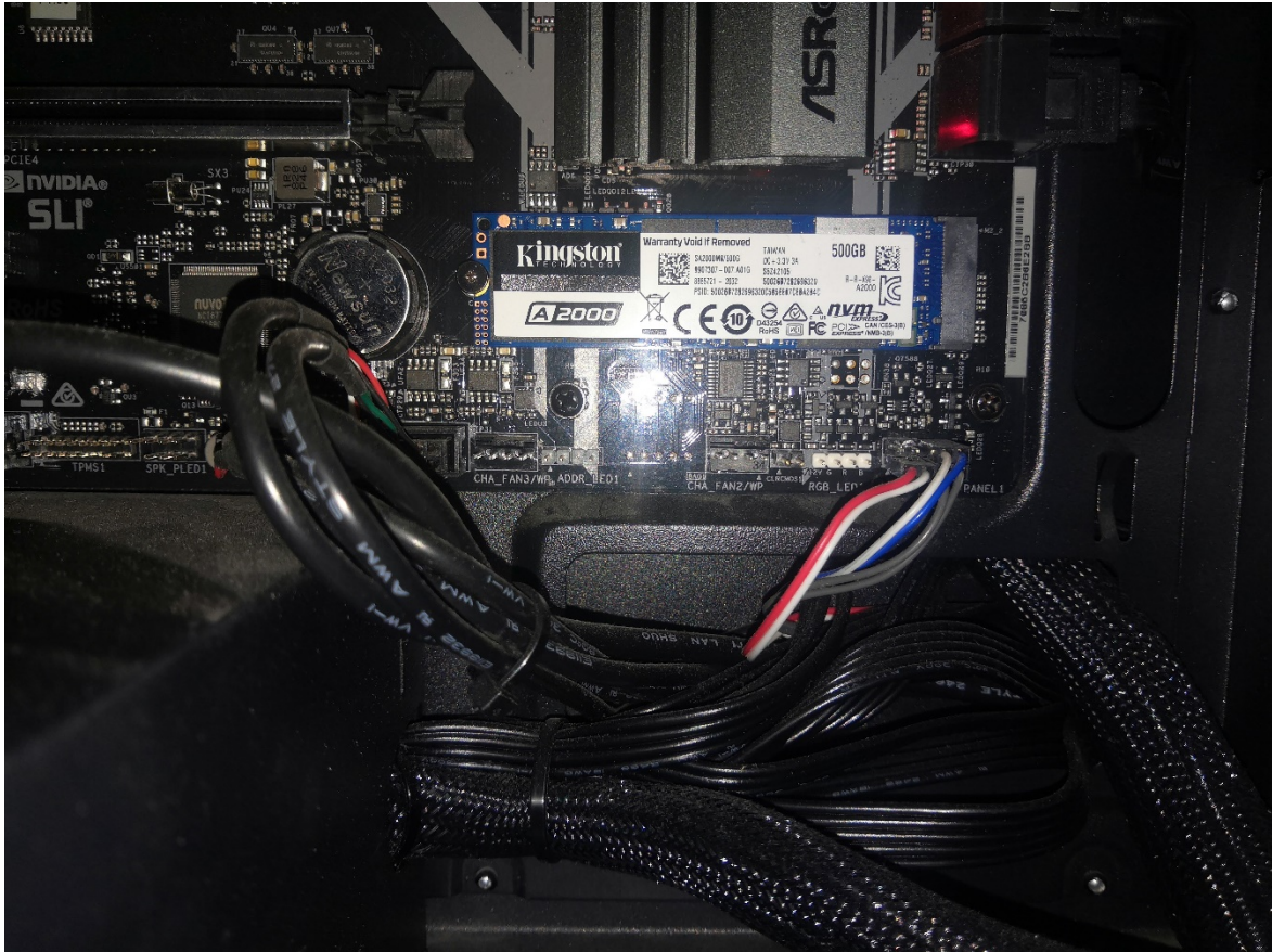
Slika 19: CMOS baterija, USB konektori i konektori prekidača prednjeg panela kućišta računala [autorski rad]
