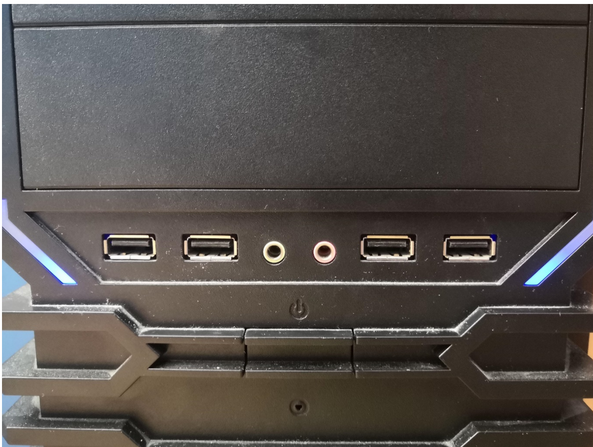
Slika 13: USB utori s prednje strane kućišta računala [autorski rad]
