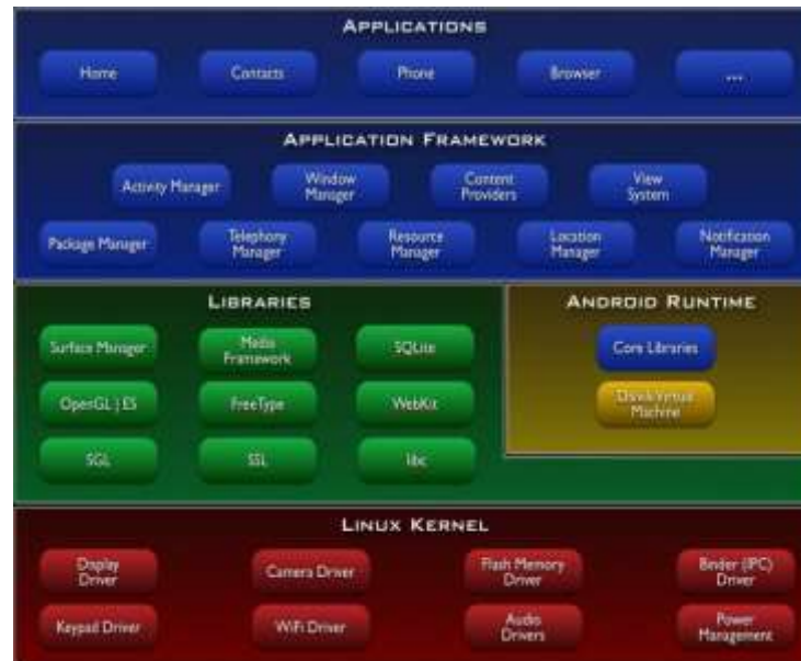
Slika 1: Android OS arhitektura (Izvor: http://android-pit.blogspot.com/2012/01/arhitektura-androida.html )
