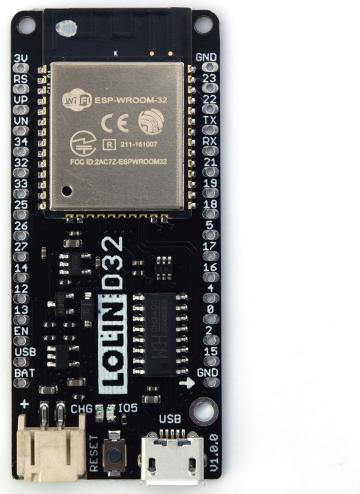
Slika 9: ESP32 pločica (Izvor: [5])
