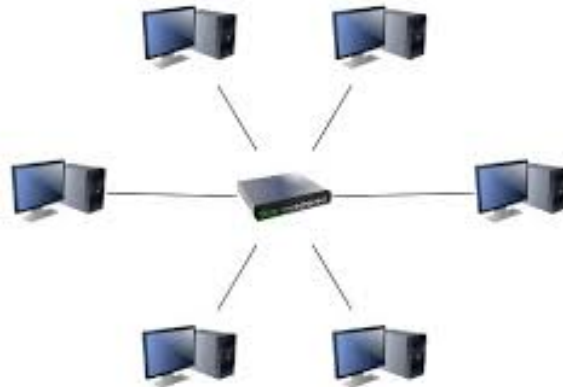
Slika 1. Prikaz LAN-mreže (Izvor: Local Area Network Lan)
