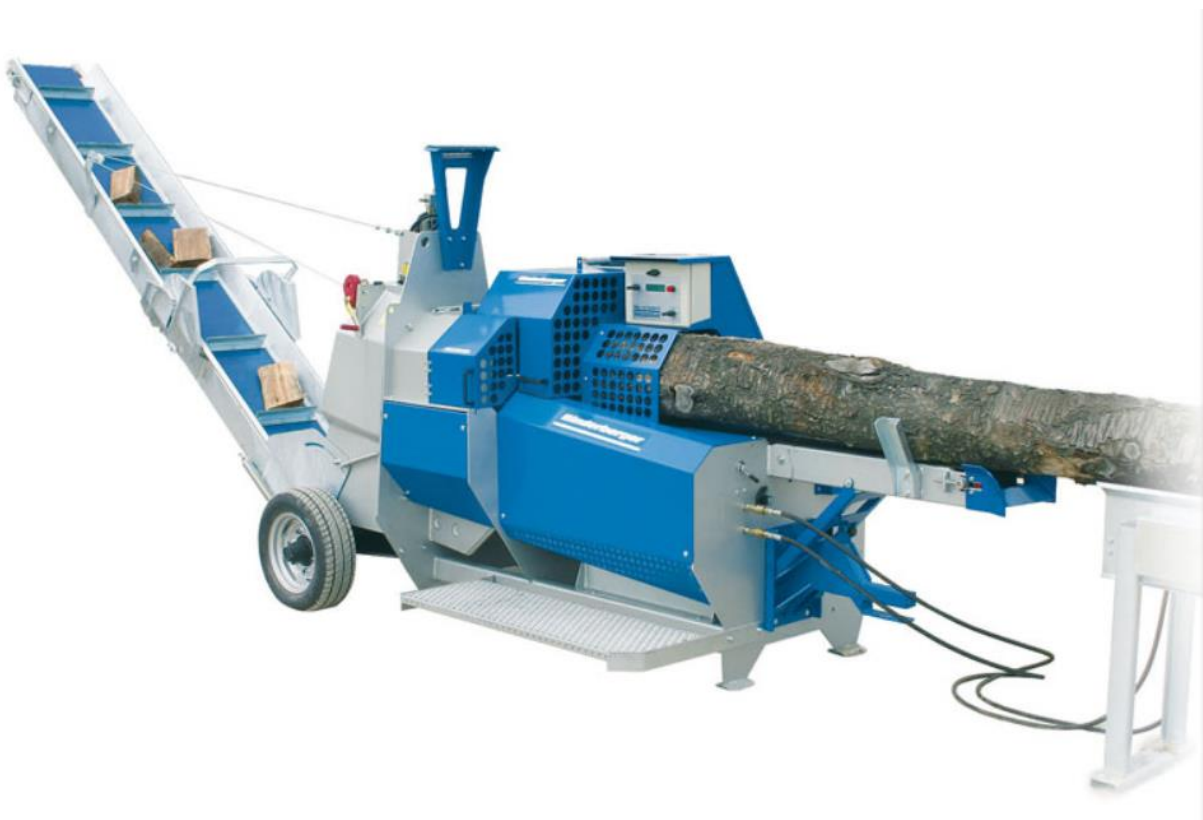
Slika 5: Cjepač za izradu ogrjevnog drva (Izvor: [17], GTP Šoštarčić dostupno na: https://gtpsostaric.com/ )
