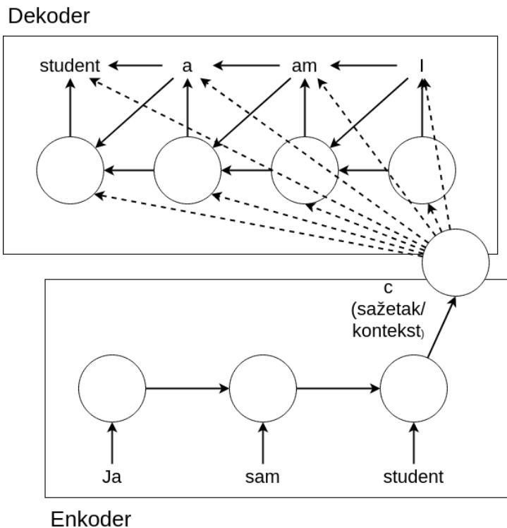
Slika 4: Enkoder - dekoder primjer (Vlastita izrada prema: Cho, Van Merriënboer, Gulcehre i dr., 2014)
