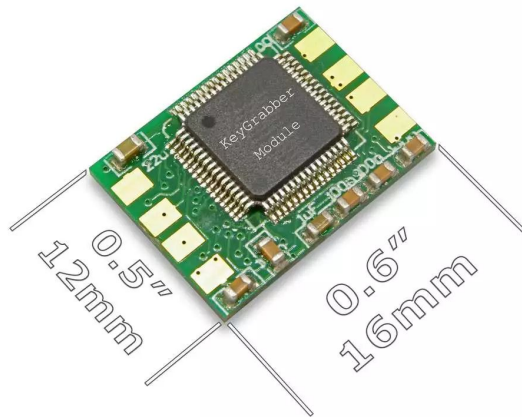
Slika 9: Ugradbeni keylogger USB sklop poduzeća Keelog [38]
