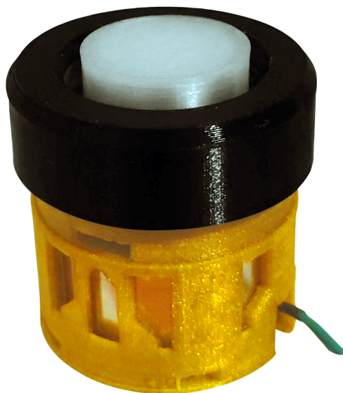
Slika 13: Slika konačnog modela elektromagnetskog gumba [autorski rad]
