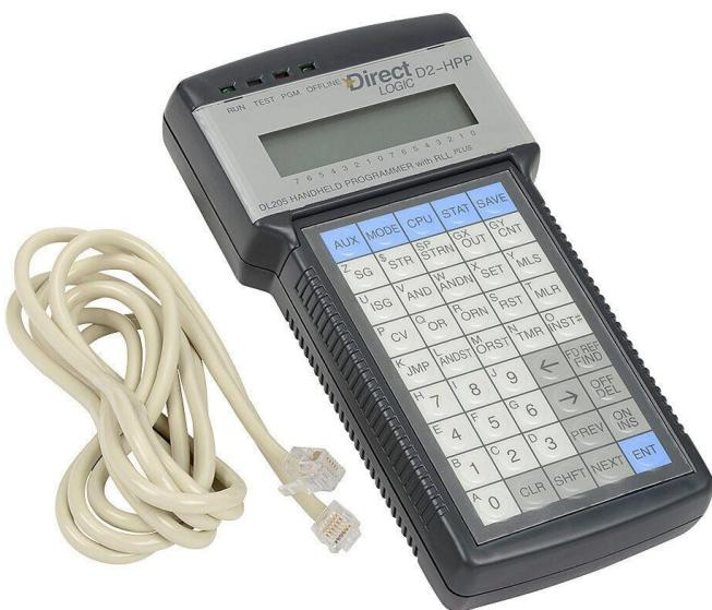
Slika 13. Ručni PLC programator (Automation Direct, 11. kolovoza 2024.)
