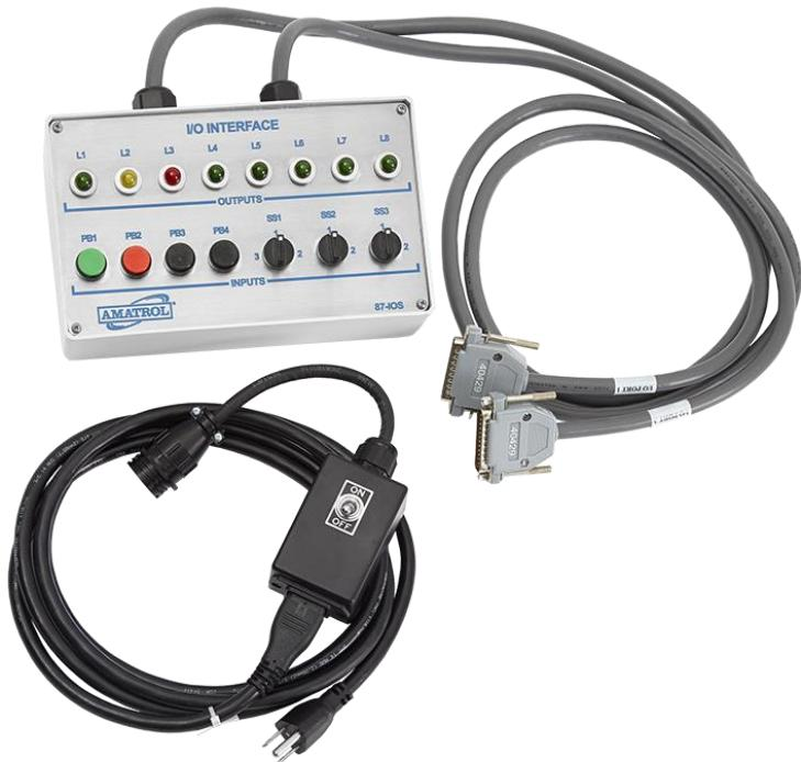
Slika 14. PLC simulator stanja (Amatrol, 12. kolovoza 2024.)
