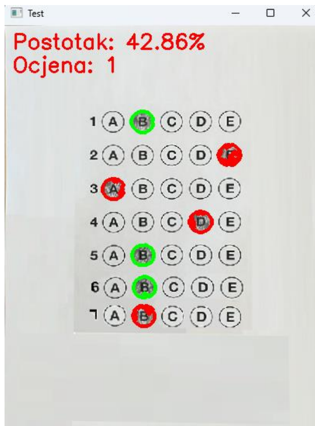
Slika 20: Primjer pogrešno obrađenog testa , točan odgovor za svako pitanje je B, nisu pronađene sve konture (Izvor: Vlastita izrada)
