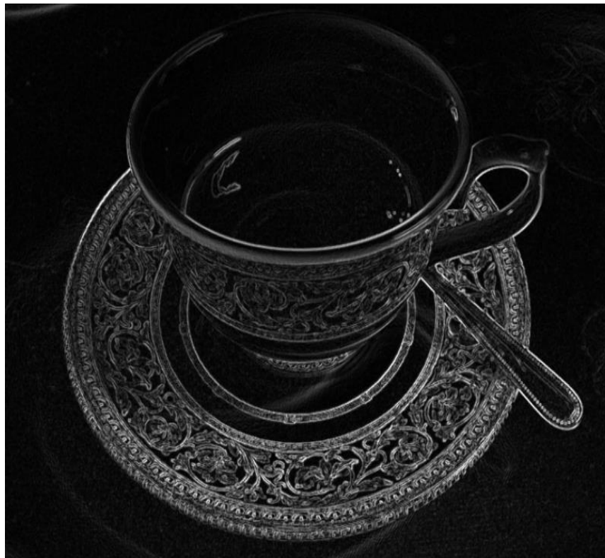
Slika 8: Primjer detekcije ruba Sobelovim Operatorom (Izvor: Vlastita izrada)
