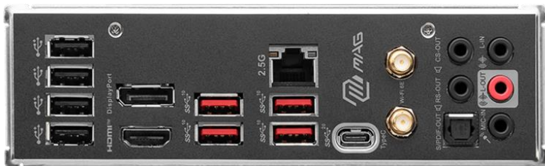
Slika 1: Vanjski priključci moderne matične ploče (Izvor: MSI [60])
