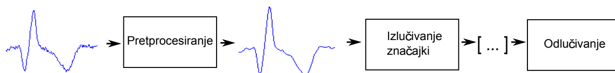
Slika 2: Tipični koraci u računalnoj obradi EKG signala
