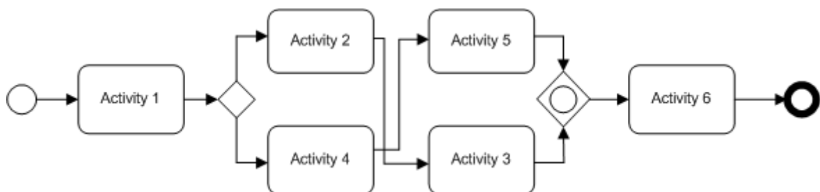
Slika 104. Anomalija Križanje i savijanje veza između elemenata
