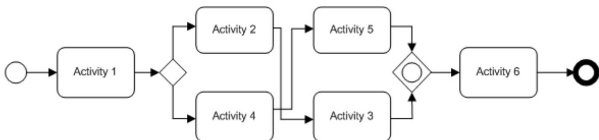
Slika 104. Anomalija Križanje i savijanje veza između elemenata
