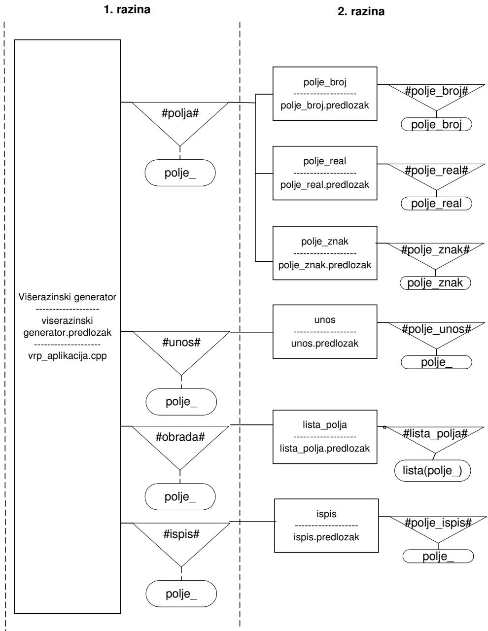
Slika 4.13: Dijagram metaskripti višerazinskog generatora aplikacija iz primjera
