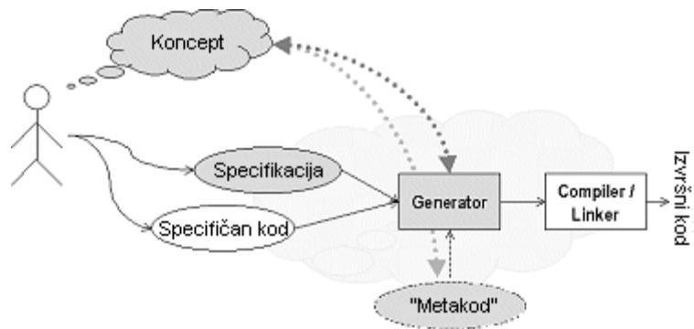
Slika 2.8: Princip generatora
