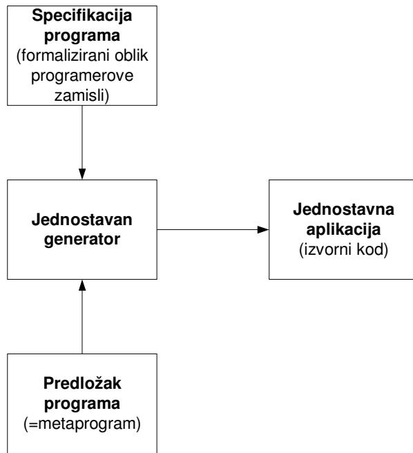
Slika 2.9. Postupak generiranja aplikacije kod jednostavnog generatora
