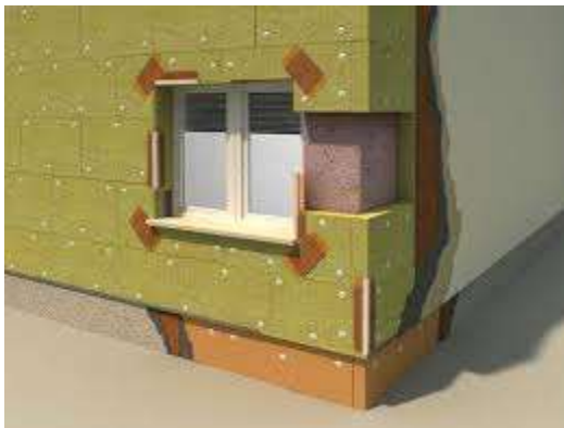
Slika 6-6. Ispravno postavljena izolacija oko vanjske stolarije ( www.knaufinsulation.hr )
