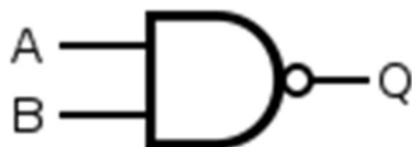
Slika 3: Simbol NAND logičkih vrata
