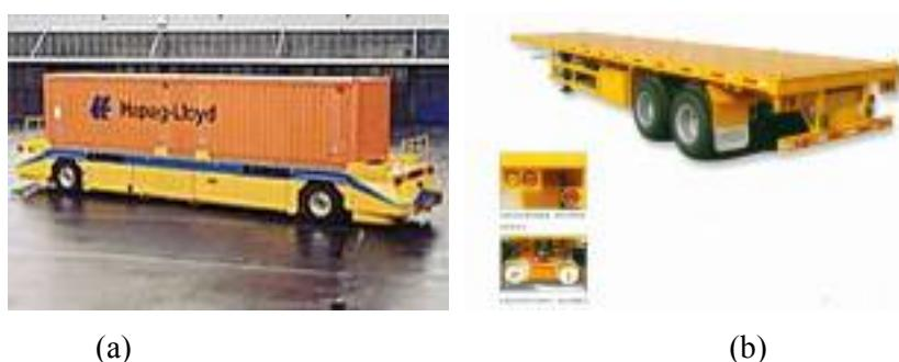
**Slika 7.3** "Pasivna" transportna sredstva na terminalu: (a) automatski upravljanje vozilo; (b) prikolica
